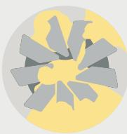
Der Einsatz von AdBlue® kann bei geringen Motor und Abgastemperaturen zu Harnstoffablagerungen am SCR-Katalysator führen und einen Abgasrückstau im SCR-System verursachen.
